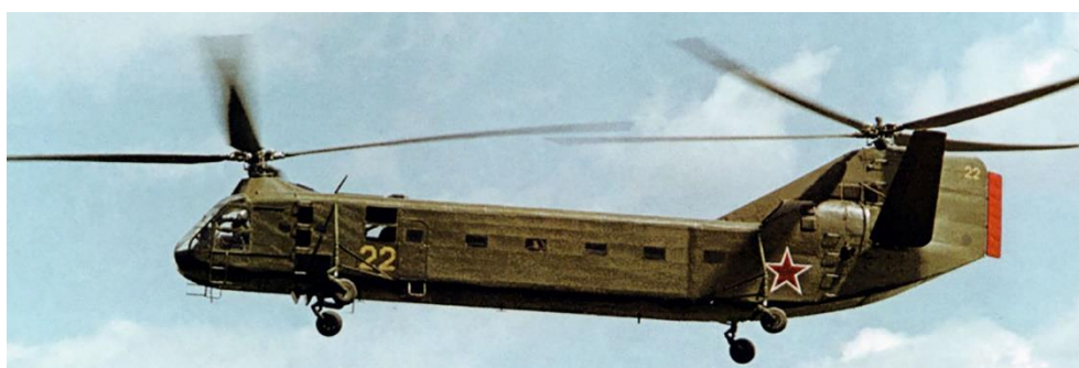
Рисунок 2.5 – Як-24, советский двухвинтовой вертолет с продольной схемой расположения винтов.
