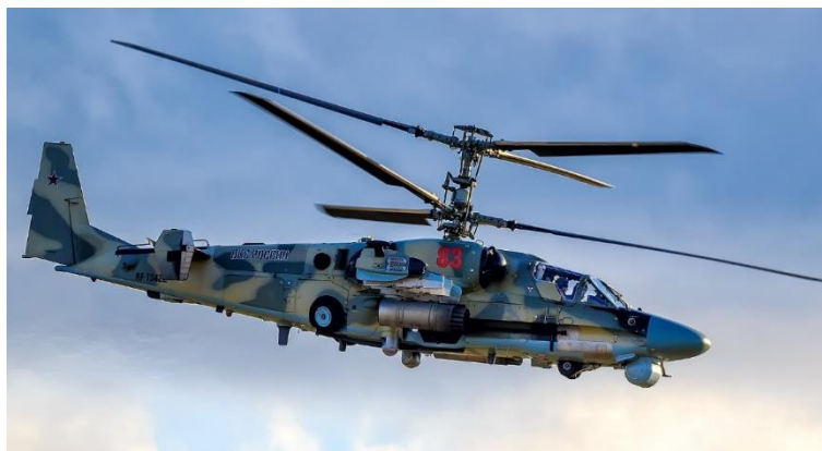
Рисунок 2.4 – Ка-52 «Аллигатор», двухвинтовой боевой вертолет с соосной схемой расположения винтов
