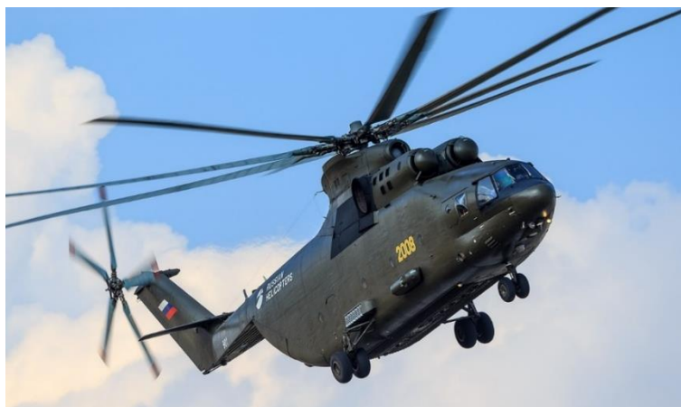
Рисунок 2.3 – Ми-26, одновинтовой вертолет с грузоподъемностью 20 тонн
