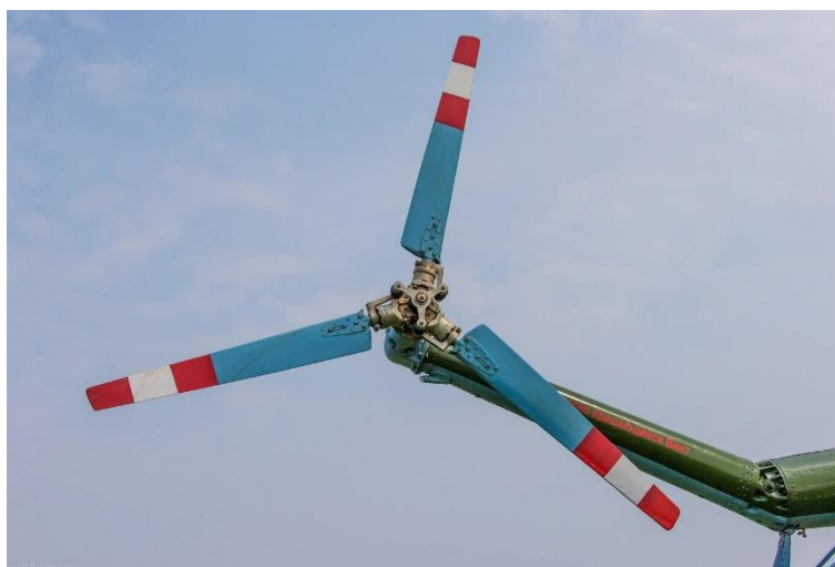
Рисунок 1.4 – Толкающий рулевой винт вертолета Ми-1
