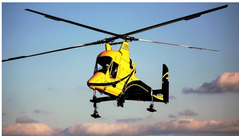
Рисунок 2.7 – Kaman K-1200 K-Max, вертолет с перекрещивающимися винтами
